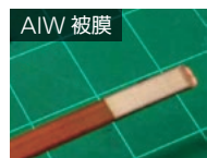
コイルの被膜除去
