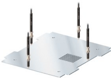
金属部品の反り測定
