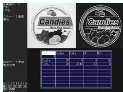
2台のカメラの画像を同時表示 (上は、濃淡と微分2値化で処理した画像)
