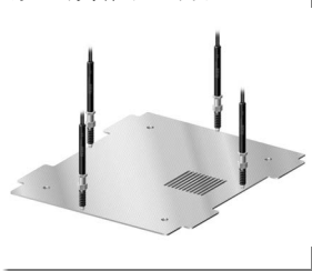
测量金属零件的翘曲变形
