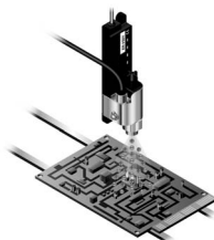
电路板上LED的放电破坏保护
