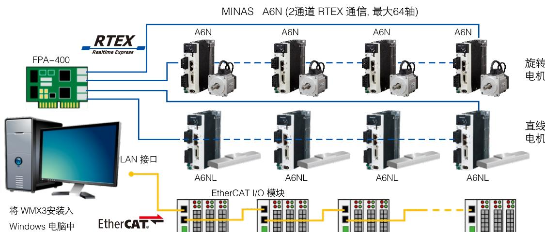
控制示例: 一台电脑可同时控制多个设备和工业机器人。
