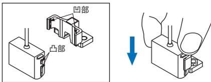
**センサ本体と専用取付具の取り外し方法**
