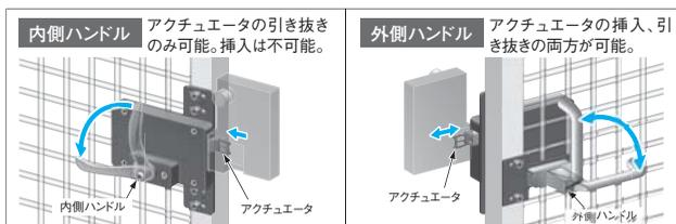
緊急脱出用の内側ハンドル付アクチュエータを使用することで、米国ロボット規格 ANSI/RIA R15.06-2012やISO 12100:2010 (JIS B 9700:2013) によって要求されている、安全防護領域から容易に緊急脱出するための方策に対応可能。
