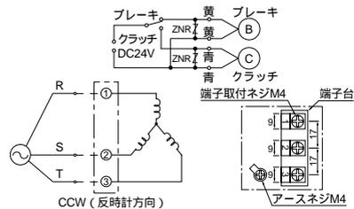
CW 時計方向 回転は、上記R・S・Tのうち、いずれか2線を入れ換えて下さい。
