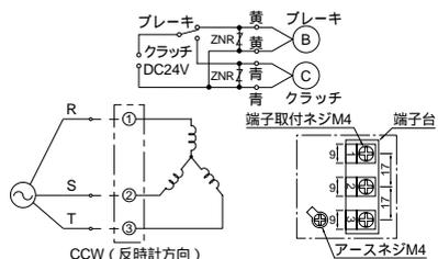
注) CW (時計方向) 回転は、上記R・S・Tのうち、いずれか2線を入れ替えて下さい。
