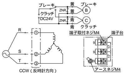
注) CW (時計方向) 回転は、上記R・S・Tのうち、いずれか2線を入れ替えて下さい。
