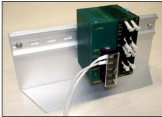
DINレールに取り付けられた PLC
